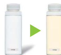
Colore dell'olio fresco di fabbrica Colore dell'olio dopo 10 anni d'uso
